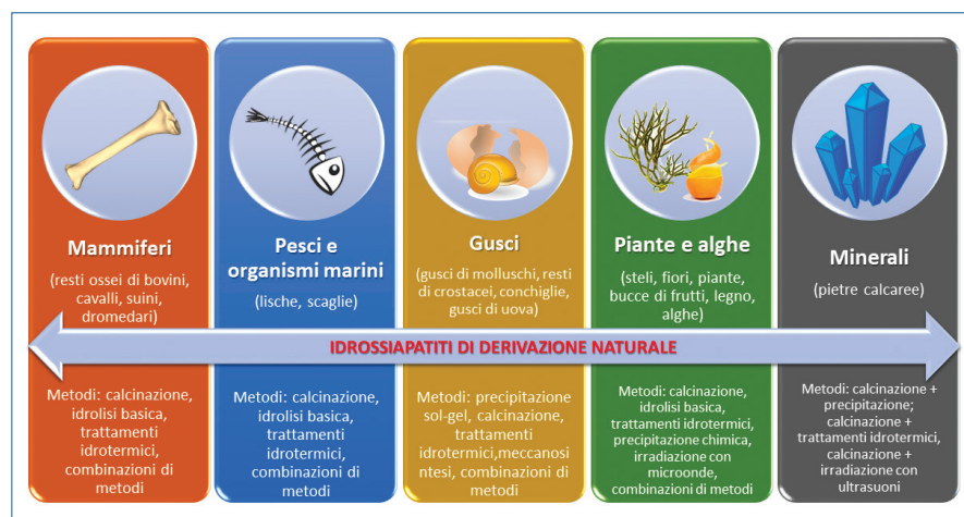
Fig. 2 - Idrossiapatite da fonti naturali e metodi per la sua estrazione (adattata da Fihri et al. [3])
