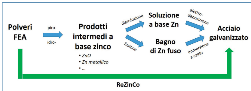
Fig. 2 - Filiera del recupero di Zn dalle polveri rivenienti dai forni elettrici ad arco impiegati nella produzione di acciaio secondario. Confronto fra l'attuale filiera "indiretta" e quella "diretta" proposta da ReZinCo
