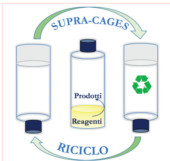
Fig. 1 - Rappresentazione schematica del riciclo del gel dopo l'estrazione dei prodotti dalla miscela di reazione
