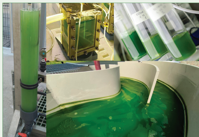
Fig. 1 - Esempi di coltivazione di microalghe in sistema aperto ("raceway open pond"), in PBR colonnari e in reattori di laboratori
