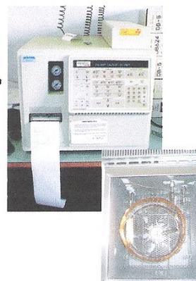
Lo studio del **cromatogramma** consente di effettuare analisi qualitative in quanto il tempo impiegato a percorrere la colonna (in identiche condizioni) è caratteristico di ogni sostanza: si può pertanto procedere ad un confronto delle miscele analizzate con campioni di composizione nota.
