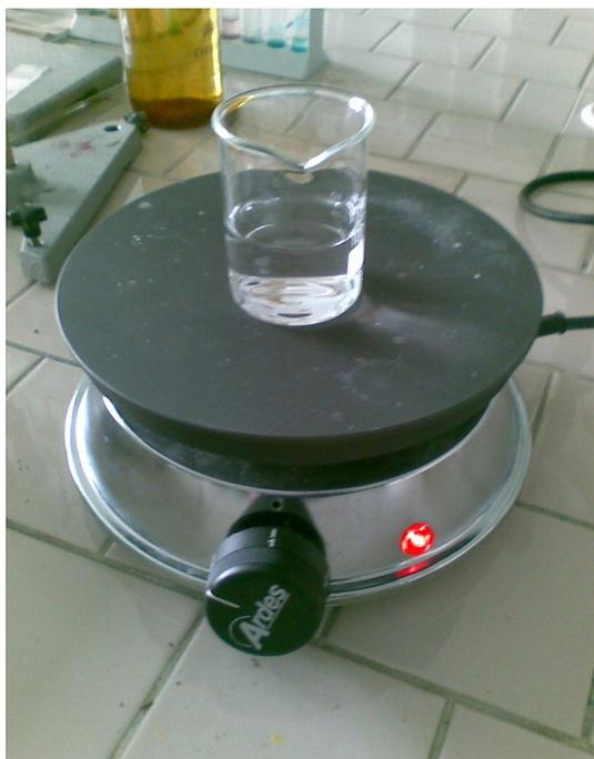
Fig. 4 -Il liquido raccolto dalla filtrazione viene posto su piastra riscaldante
