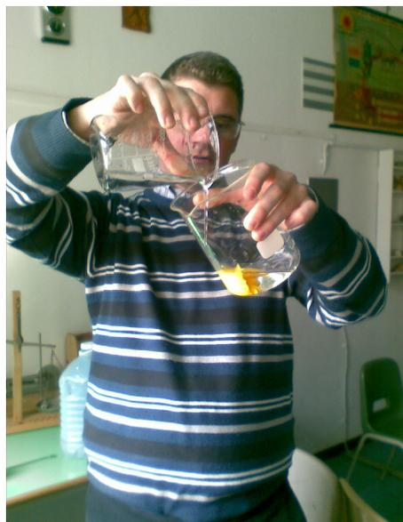
Fig. 1 -Mescolando la soluzione di ioduro di potassio con quella di nitrato di piombo si forma immediatamente un miscuglio giallo
