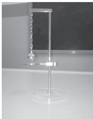
Figura 9 - Apparecchio per evidenziare la dilatazione dei solidi: l'anello di Gravesande
